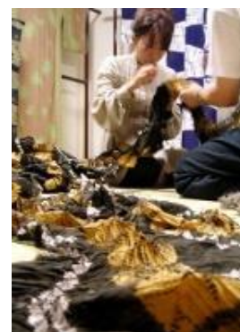
絞りの糸抜き工程
