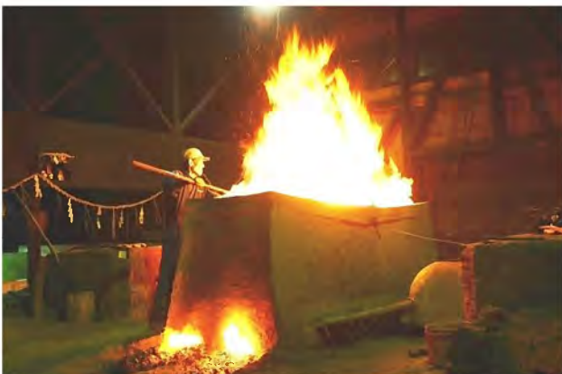
⑩ たまはがね 玉鋼製造（たたら吹き）伝承
