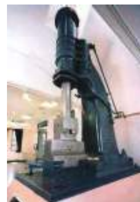
スチームハンマー-0.5t 片持型 横須賀製鉄所設置 1865 年オランダ製
